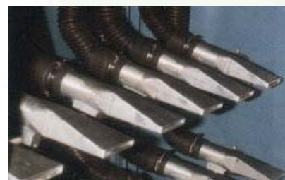
風力式低温水切り乾燥機 (ノズル部分の拡大)
